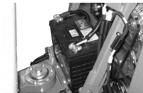
Аккумулятор, передняя обшивка снята
