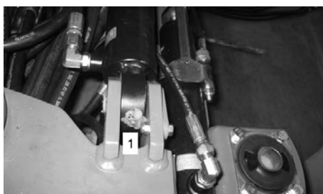
1 Точка смазки подъемного цилиндра Находится сзади, под кабиной.
