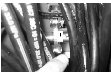
1 Точка смазки тяги тормозного привода Находится под днищем кабины.
