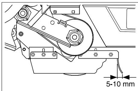
Расстояние задней уплотнительной планки до пола установить так, чтобы при инерционном выбеге она отклонялась назад на 5...10 мм.
