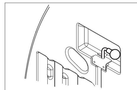
→ Поставить переключатель "Повторное использование воды/использование чистой воды" в положение "Повторное использование воды".
