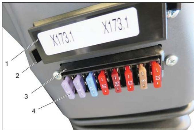
Основные предохранители находятся справа под рулевым колесом.
