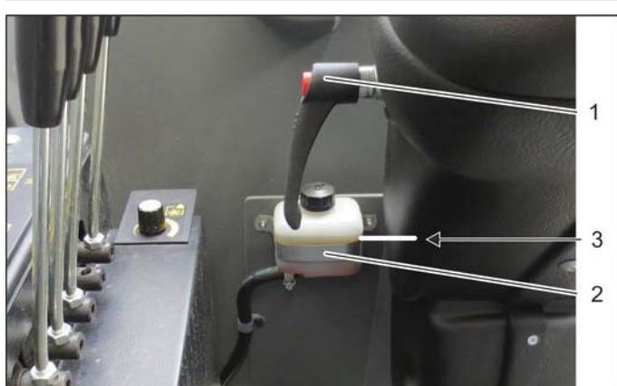
1 Рычаг регулировки рулевого колеса
